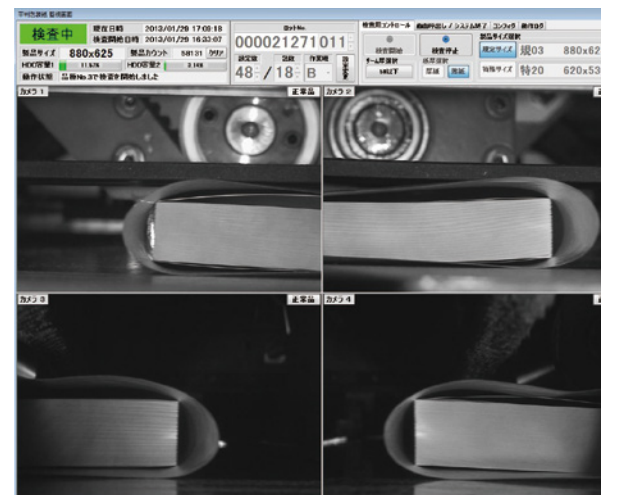
平判包装機角折れ検出装置 検査画面 (於：製紙工場)
