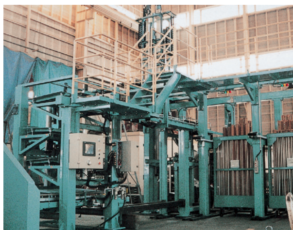
紙管自動供給装置 (於：製紙工場)
